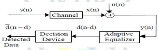
**FIG 1: CHANNEL EQUALIZATION**
