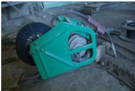
Fig. 2 Mig Welding Apparatus
