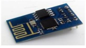
Fig. 3. ESP8266 Wi-Fi Module
