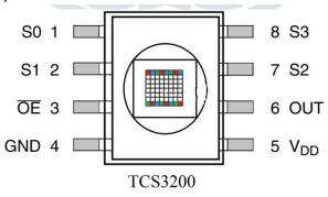
Fig: Pin Diagram of TCS3200
