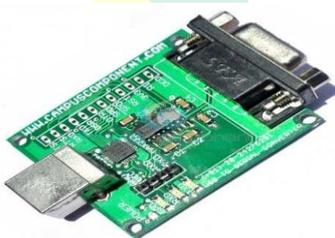
figure4(d) serial communication RS232
