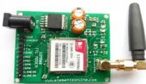
figure4(c) GSM module
