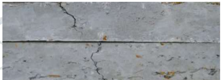
Fig: 7. Flexural crack
