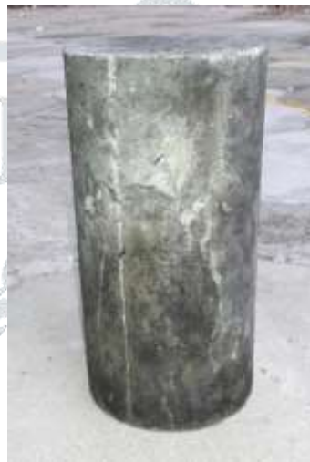
(d) Crack Pattern of Cylinder after Testing
