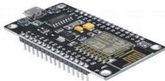
Fig 3. ESP8266 wifi module
