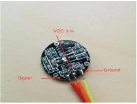
Fig 3 : Pulse Sensor
