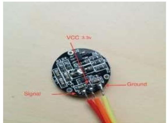
Fig 3 : Pulse Sensor
