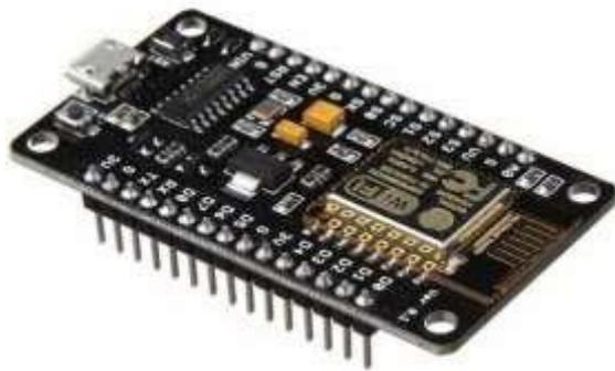
Fig 1 : ESP8266 Module
