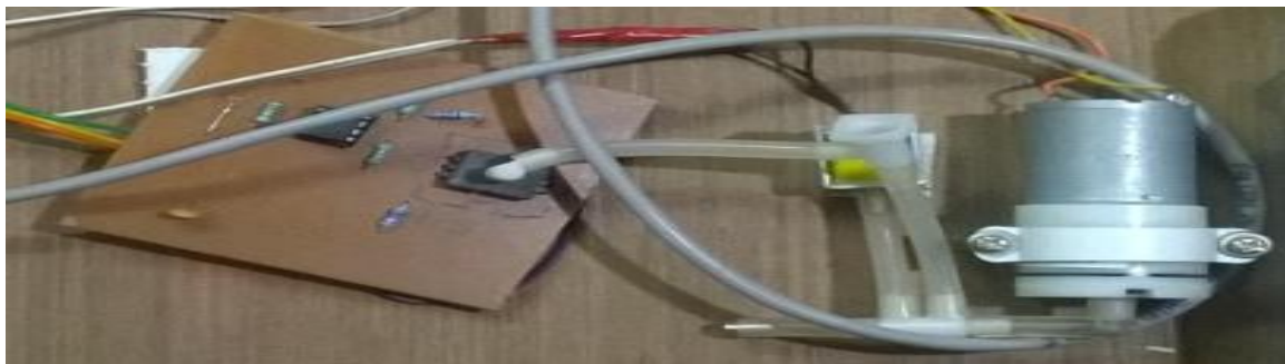
Fig 4.4 Hardware ckt of BP Amplifier Ckt
