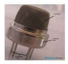
Figure 4: LPG GAS Sensor
