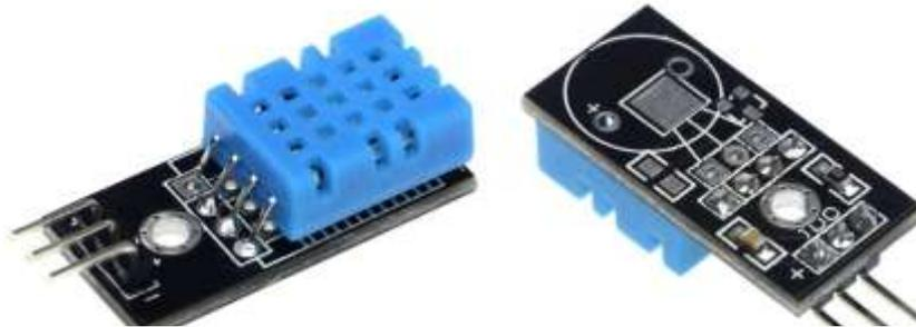
Figure 6 DHT Sensor
