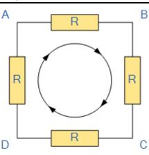
$$V_{AB} + V_{BC} + V_{CD} + V_{DA} = 0$$
