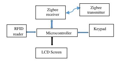
FIG.3.COMPONENTS OF SMART TROLLEY
