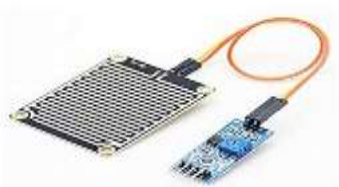
Fig: Rain sensor
