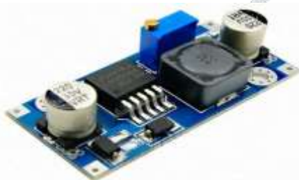
Fig: DC-DC Buck converter
