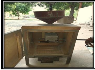
Fig. 2.10 Sand Blasting Test Apparatus
