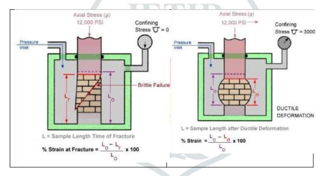
STRAIN AT FRACTURE
