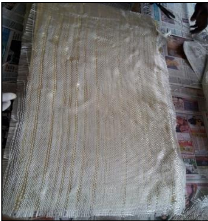
(d) Cut glass fibre
