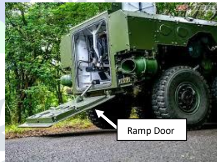
Fig. 2 Ramp Door Assembly
