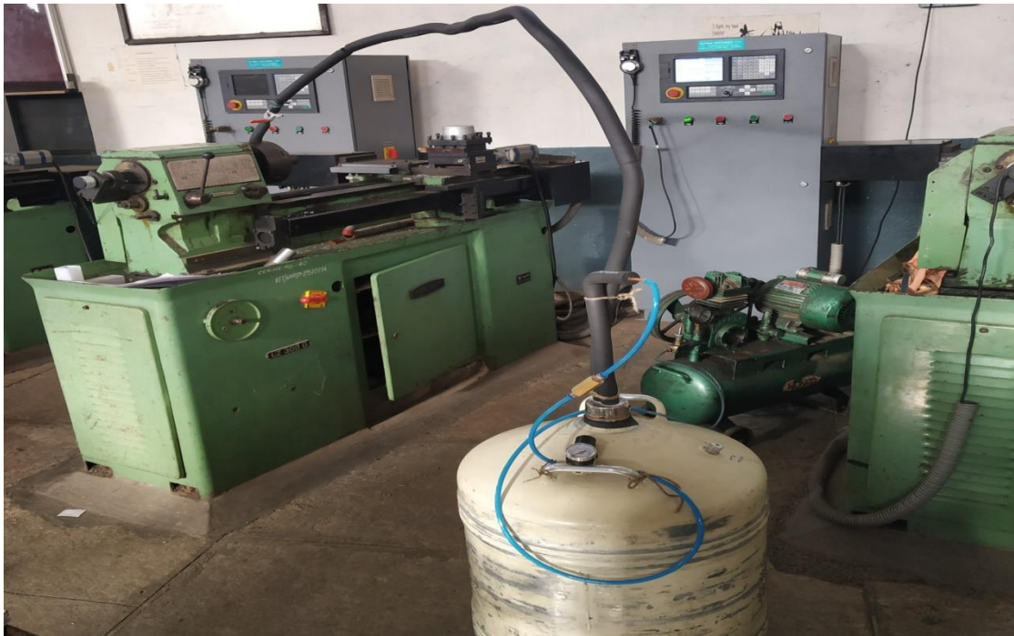
Fig. 3.1 Actual cryogenic machining set-up
