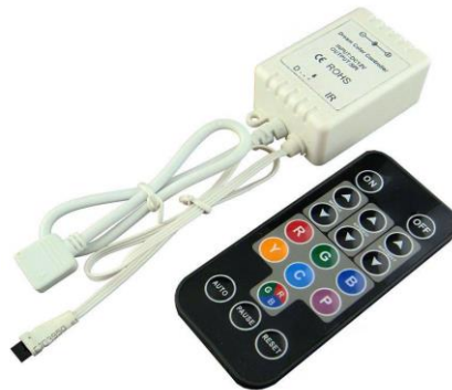
Fig-4 IR Remote Control
