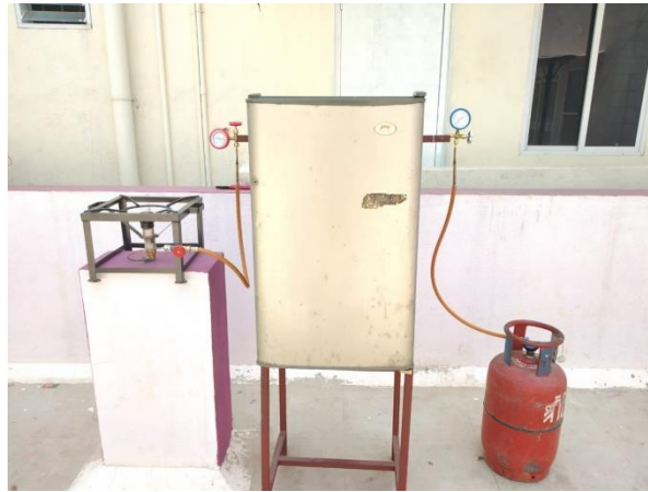
Fig-2: Actual Setup of LPG Refrigerator
