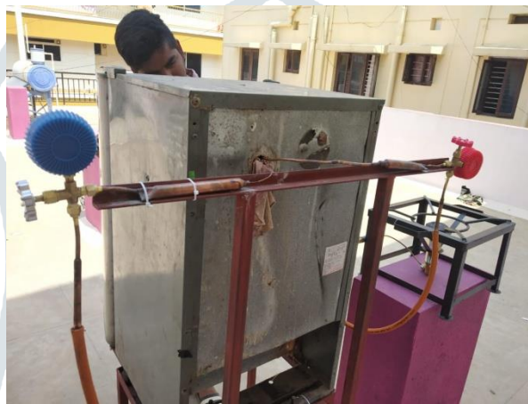
Fig-2: Actual Setup of LPG Refrigerator
