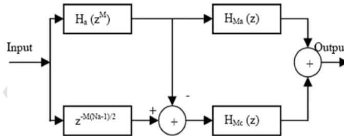
FIGURE 3 : FIR FILTER ARCHITECTURE BASED ON FRM TECHNIQUE.
