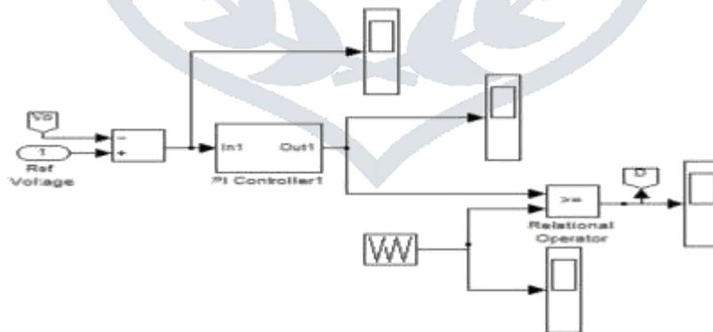
Fig.3.2 Rectifier Control Scheme
