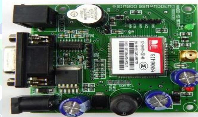
**Fig. 4 GSM Module**
