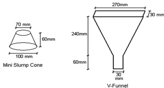
Fig.3: Dimensions of the mini slump cone and mini V-funnel apparatuses
