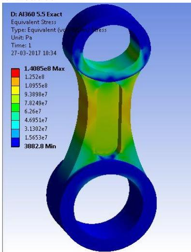
Fig15: Equivalent Stress
