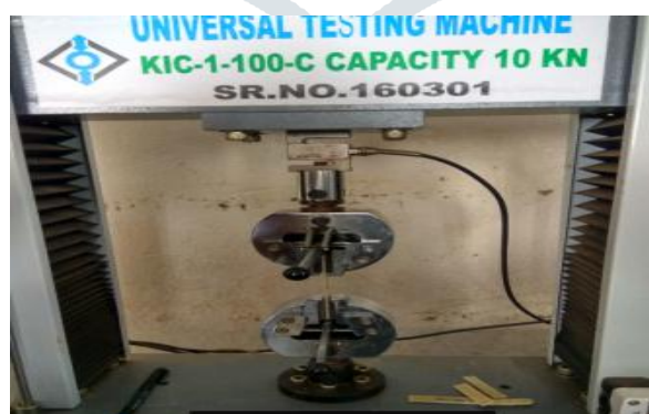
Figure no: 2 Tensile test set up
