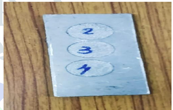
fig 5.al alloy 6082 afetr machinig material
