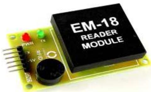
Fig: RFID module
