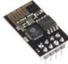
Fig: ESP8266 module
