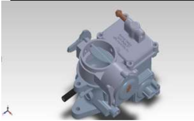
Actual model of carburetor
