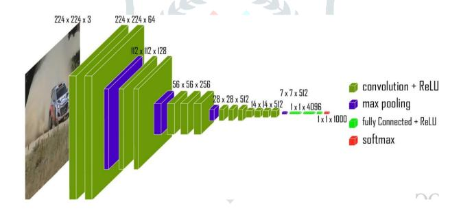
Fig: VGG16 CNN model(gfg)
