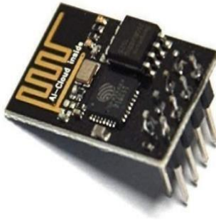
Fig 2(d): ESP8266 WIFI Module
