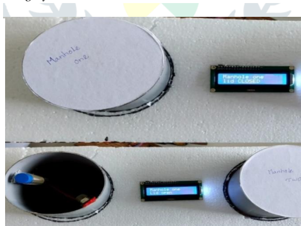
Fig (7): Manhole-1 Lid Status
