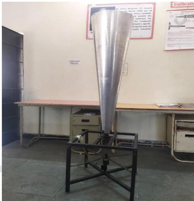
Fig1: Vortex Wind Turbine
