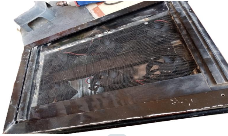
Fig. 3.2 Fan Cooled Layer
