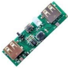
Fig: Charging Module
