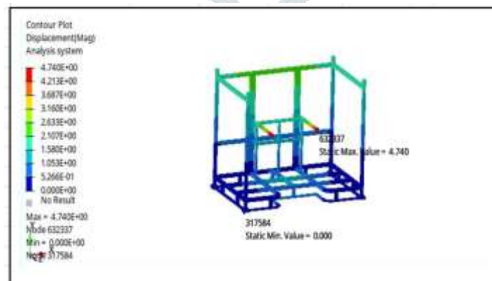
Fig. 6 New trolley Displacement.
