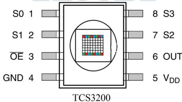
Fig: Pin Diagram of TCS3200
