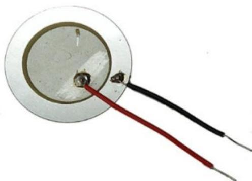
Fig. 2. A piezo crystal or disc
