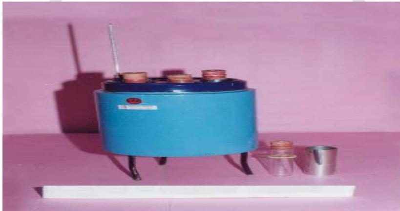
**Fig 2: Cloud and pour point setup**
