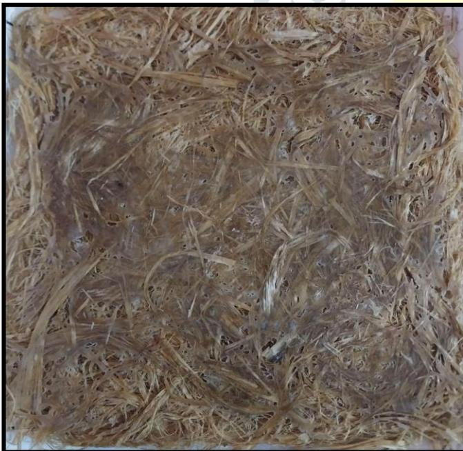
Fig. 5 Hemp Fibre Composite
