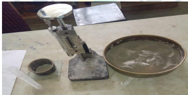
Figure No : 3.6 Vicat Apparatus
